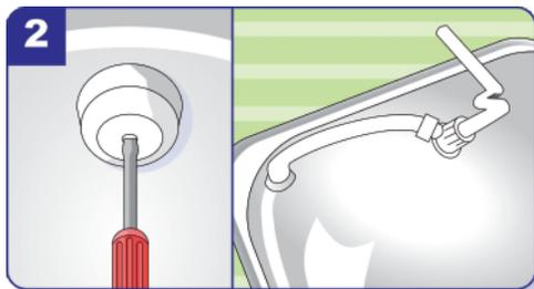
**2** Anschließend wird der Siphon an den Wannenablauf montiert.
