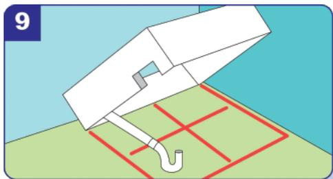
**9** Stahlwannen unbedingt vom Elektriker erden lassen. Zunächst müssen die Durchgänge für den Abfluss und die Revisionsöffnung ausgesägt werden.
