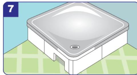
**7** Wannenrand untermauern und unbedingt eine Revisionsöffnung für den Zugang zum Ablauf lassen. (Fliesen- und Kleberdicke berücksichtigen)
