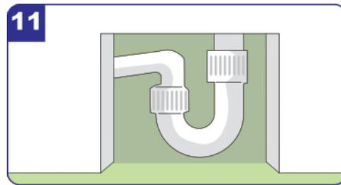
**11** Nach Anschluss des Ablaufes an das Fallrohr und Dichtungsprüfung kann die Erdung der Wanne durch den Elektriker erfolgen.
