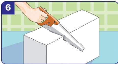
**6** Für die Umkleidung der Duschwanne die Blöcke aus Porenbeton zuschneiden.
