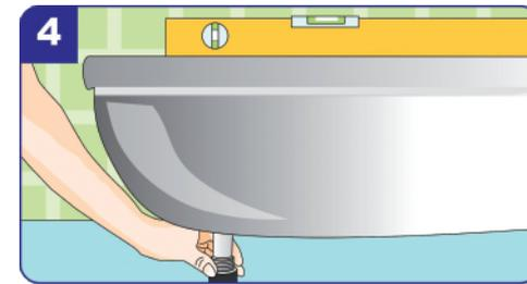
**4** Die Duschwanne mit der Wasserwaage ausrichten. Die Duschwanne erhält ausreichende Standfestigkeit durch Montage der speziellen Haltewinkel.
