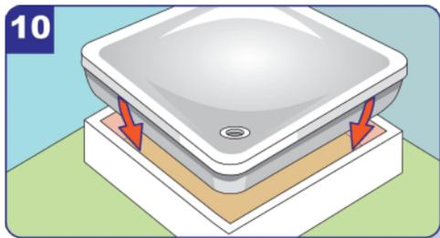
**10** Der Wannenträger wird mit Mörtel/Kleber auf dem Boden befestigt. Die Wanne kann nun in den Wannenträger gestellt und ausgerichtet werden.
