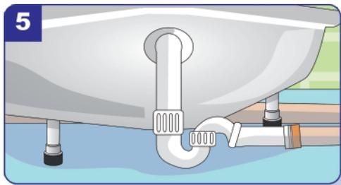
**5** Abfluss mit HT-Rohr am nächsten Fallrohr anschließen. Das Gefälle sollte mindestens 2 cm pro Meter betragen. Nach Anschluss auf Dichtigkeit prüfen.
