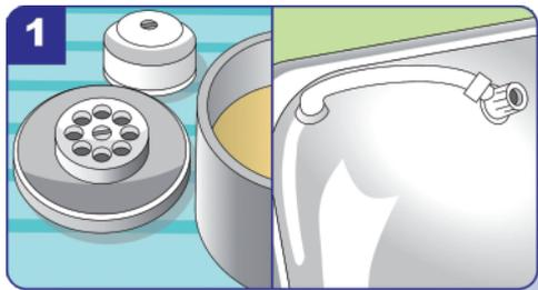
**1** Zunächst die Ablaufgarnitur, den Überlauf bei tiefen Wannen und das Abflusisieb montieren.
