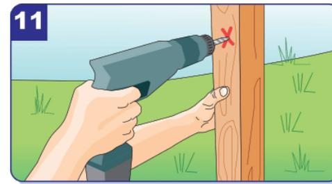
An den Markierungen nehmen Sie nun die Bohrung vor. Bei höheren Elementen, sollten Sie auch einen L-Beschlag in mittlerer Höhe anbringen.
