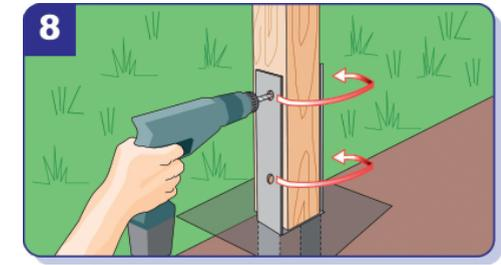
Bei beiden Befestigungsarten gilt: Pfosten einsetzen, ausrichten und anschließend von beiden Seiten durch die oberen Löcher bohren und mit Maschinenschrauben befestigen.
