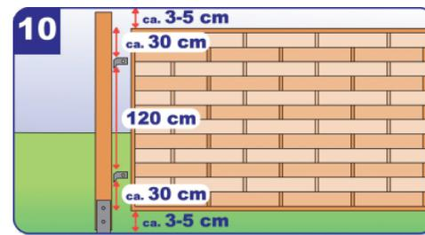
Das Zaunelement sollte rund 10 cm niedriger als der Pfosten sein. Zur Befestigung der L-Beschläge markieren Sie die Bohrlöcher in der Pfostenmitte ca. 30-35 cm vom oberen und unteren Pfostenende.
