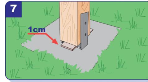
Zwischen den Pfostenträger und Pfosten lassen Sie 1 cm Abstand. Als Abstandhalter nehmen Sie einfach ein Holzstückchen, dieses entfernen Sie nach der Montage wieder.
